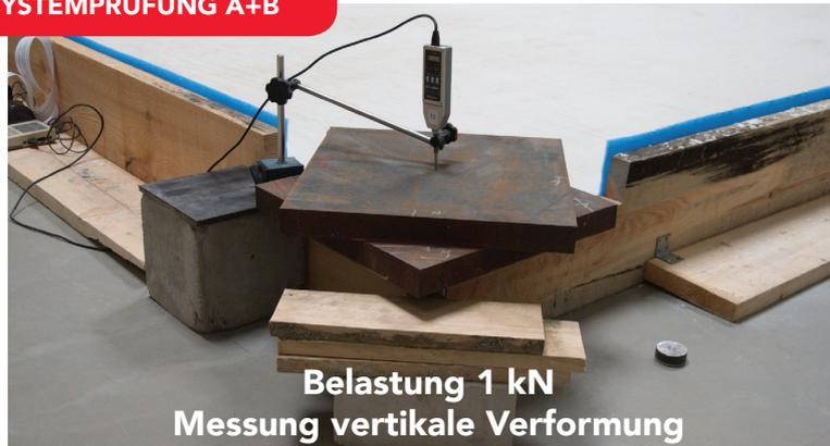
SYSTEMPRÜFUNG A +B zum Trag- und Verformungsverhalten durchgeführt im IBF Troisdorf:
